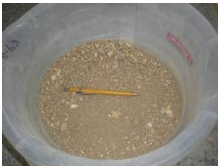
Figura 2 - Solo da jazida de Campo Grande/RJ (2010), após secagem e destorroamento.
